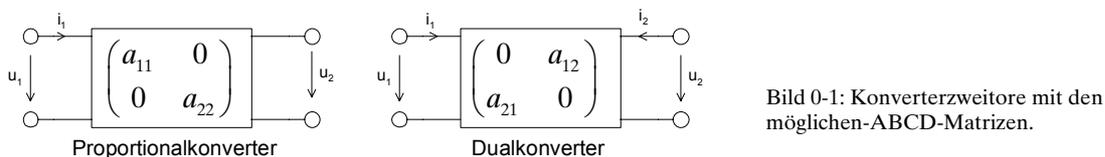
Werden diese Zweitore nach Bild 0-1 mit der Impedanz  $Z_2$  abgeschlossen gilt für die Eingangsimpedanz  $Z_1$ :
