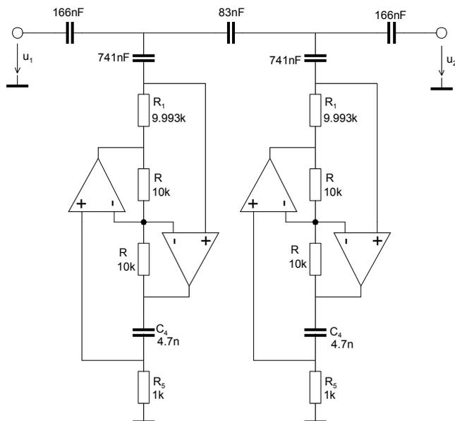
Bild 0-6: Aktive Realisation des Hochpassfilter nach Beispiel 2.
