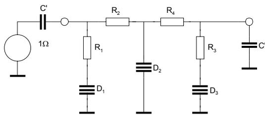
Bild 0-10: Bruton-transformierte Tiefpass nach Bild 0-9.
